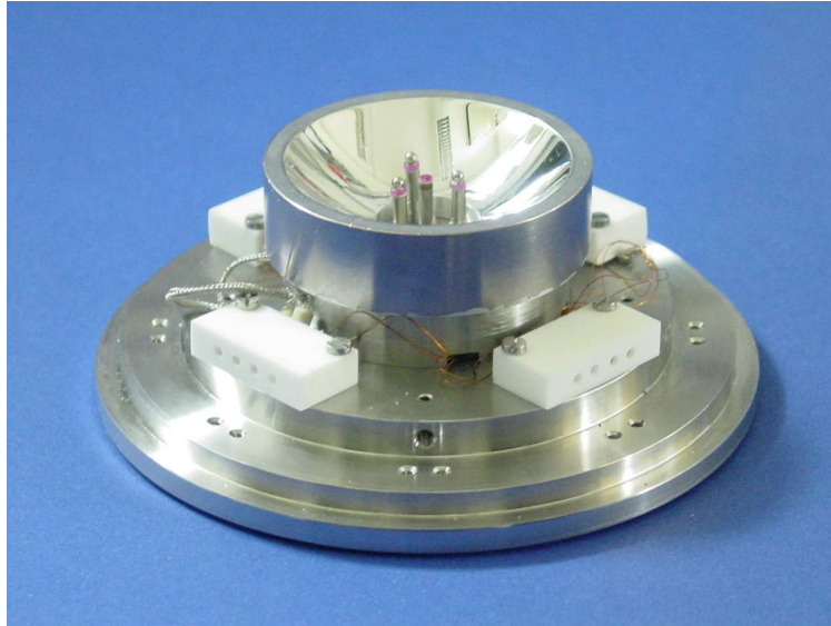
Abbildung 4.3: STM-Kopf mit Parabolspiegel zur Bündelung der aus dem Tunnelkontakt emittierten Lichtstrahlen.
