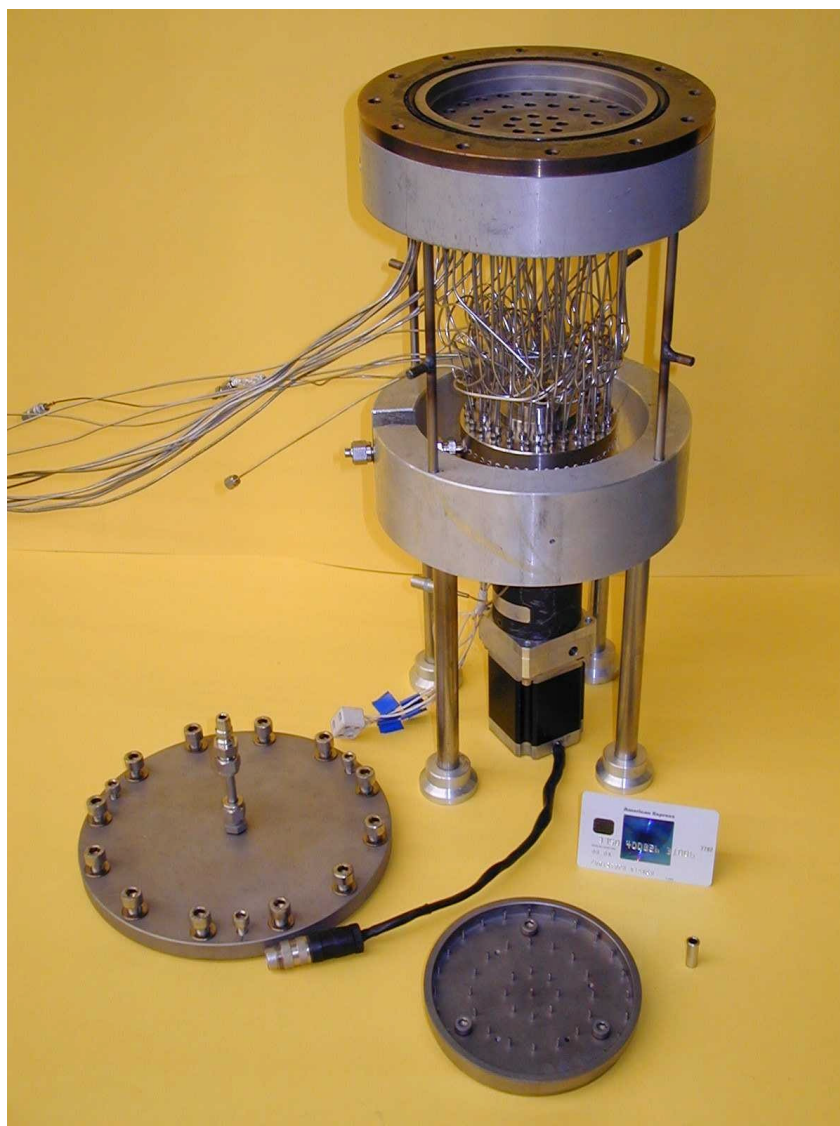
Abbildung 3: „High throughput“ Reaktor für den gleichzeitigen Test von bis zu 49 Katalysatorproben.
