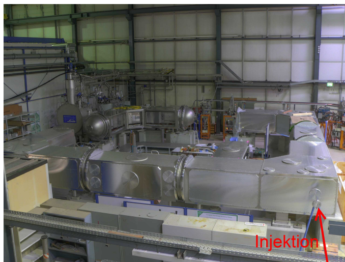
Abbildung 1.1: Das Foto zeigt den Aufbauzustand des CSR am 11. März 2011. Rechts vorne im Bild ist die zukünftige Injektionsöffnung zu sehen.[1]
