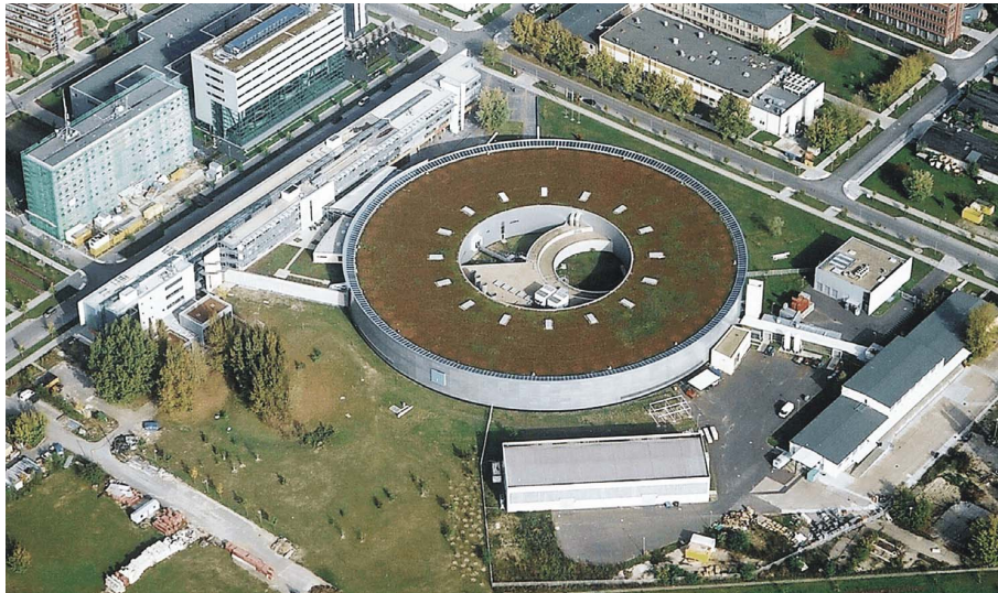
Abbildung 4.5: Luftaufnahme von BESSY II. Speicherring-Halle und Synchrotron-Tunnel sind gut erkennbar (vergleicht Abbildung 4.6) © EUROLUFTBILD, mit freundlicher Genehmigung des HZB.
