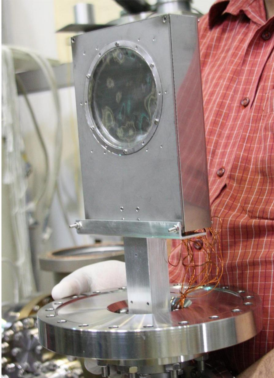
Abbildung 3.6: Der fertig aufgebaute Detektor, montiert auf dem zur Befestigung in der Vakuumkammer benötigten Flansch. Erkennbar sind die Eintrittsöffnung in der Grundplatte mit dem darüber gespannten Netz und, in deren Innerem, Teile des vorderen MCP-Halteringes. Die MCPs sind als dunkle Fläche in der Öffnung erkennbar.
