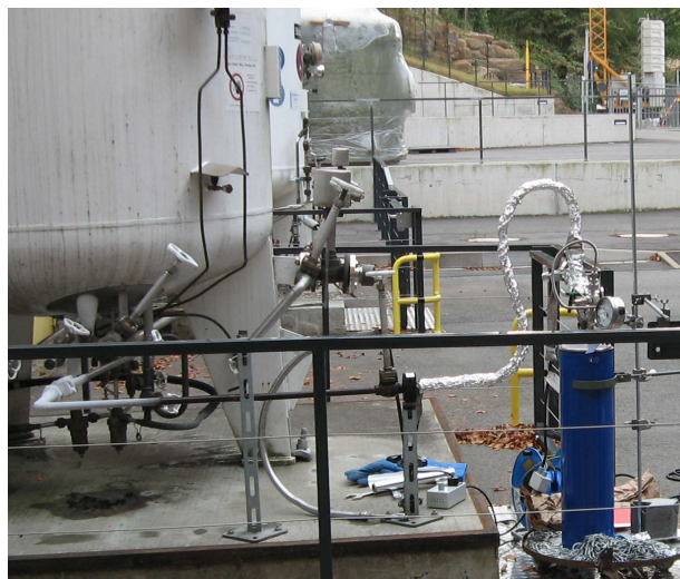
Abbildung 3.6: Im Foto ist der Füllvorgang der LARTRAP mit LAr zu sehen. An der Aluminiumfolie, die um den Verbindungsschlauch zwischen dem großen LAr-Vorratstank auf der linken Seite und der LARTRAP, die sich in diesem Bild bereits in ihrem Kühldewar befindet, kann noch erkannt werden, ab wo das System vor dem Füllen ausgeheizt wurde.
