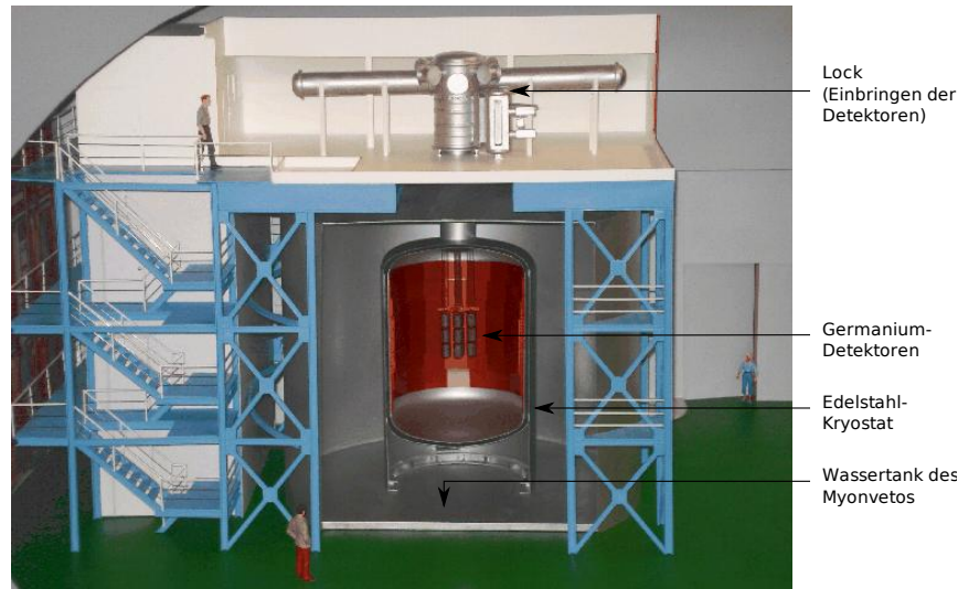
Abbildung 1.1: Foto eines GERDA-Modells. Zu sehen ist der prinzipielle Aufbau der nackt in einem mit LAr gefüllten Edelstahl-Kryostaten betriebenen Germaniumdetektoren. Im Kryostaten kann das zusätzlich angebrachte Kupfer deutlich erkannt werden. Mittlerweile ist eine mechanische Barriere gegen eine konvektionsbedingte Fokussierung von ^{222}\text{Rn} -Atomen auf die Detektoren installiert, die in diesem Modell noch nicht vorgesehen war.
