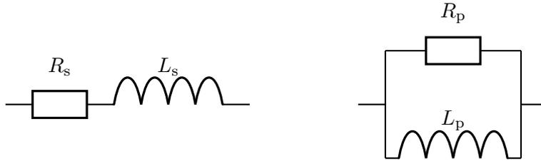
Abbildung 2.12: Ersatzschaltbild einer Induktivität in Reihen- und Parallelschaltung.
