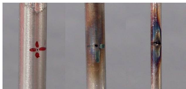
**Abbildung 3.10:** Edelstahlröhrchen, links vor dem Experiment ( $\varnothing=5\text{mm}$ ), Mitte und rechts nach dem Experiment ( $\varnothing=3\text{mm}$  bzw.  $1\text{mm}$ ).
