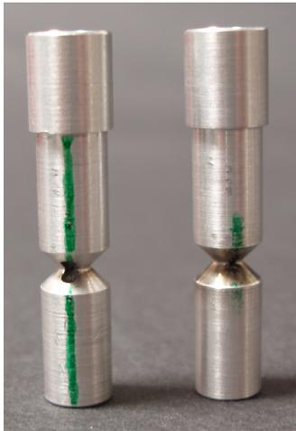
**Abbildung 3.11:** Aluminiumröhrchen vor und nach dem Experiment.
