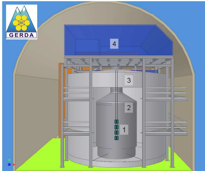
Abbildung 1.6: Querschnitt des Aufbaus des GERDA-Experiments in Halle A am LNGS: 1. ^{76}\text{Ge} -Dioden-Array; 2. Kryostat (gefüllt mit Flüssig-Argon); 3. Wasser-Čerenkov-Detektor (gefüllt mit ultrareinem, deionisiertem Wasser); 4. Reinraum mit Locksystem. Quelle: Mod. Graphik nach [Cat06]
