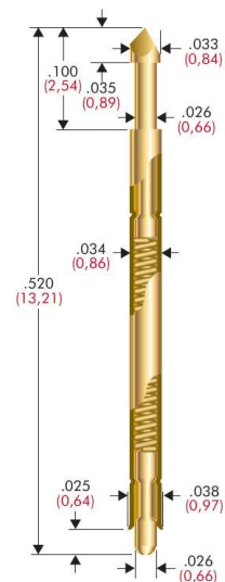
Abbildung 4.7: Pogo-Pins von IDI; rotgefärbte Zahlen entsprechen den Dimensionen in [mm].
