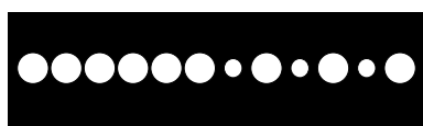
Abbildung 2.8: ASE-Blende für ein verbessertes Bündelprofil. Versuchen zufolge müssen die Durchmesser in einem exakten Verhältnis zueinander stehen, um den gewünschte Effekt zu erzielen.
