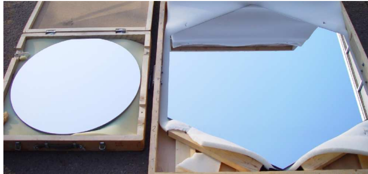
Abbildung 4.14: Grössenvergleich eines 60cm H.E.S.S.-Spiegels, links, und einem Prototypen eines hexagonalen Spiegels
