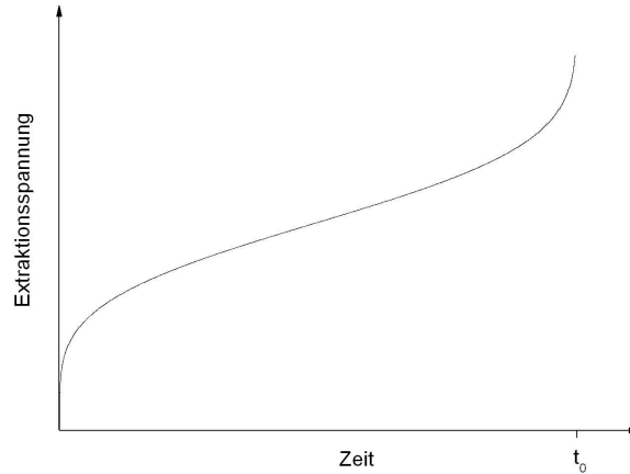
Abbildung 3.7: Extraktionsspannungsmuster, welches anhand von Referenzwerten aus dem Beschleunigungsspannungsmuster berechnet wurde.
