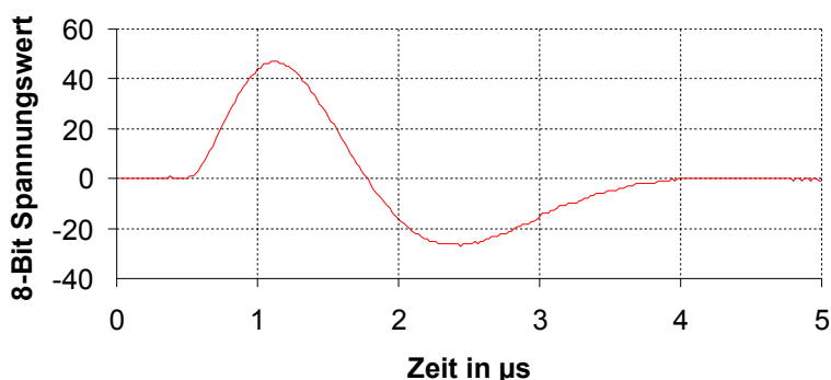
Abbildung 43: Ein NaJ(Tl)-Puls nach dem Hauptverstärker. Aufgenommen mit der PC-Karte (50 Mhz-Abtastrate)
