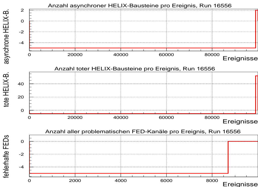
Abbildung 3.6: Das Zeitverhalten der Anzahl asynchroner (oben) und toter (Mitte) Auslesechips sowie aller problematischen FED-Signalleitungen (unten) gegen die Anzahl der Ereignisse für Datennahmelauflauf 16 556
