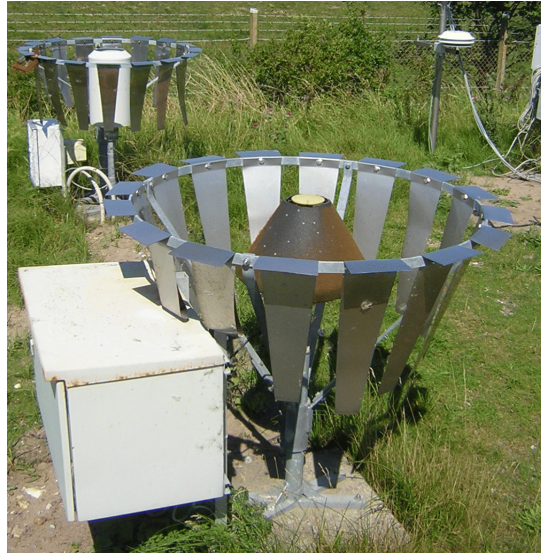
Abbildung 2.1: Joss-Waldvogel Disdrometer des Deutschen Wetterdienstes in Westermarkelsdorf. Zur Reduzierung des Messfehlers aufgrund turbulenter Umströmung des Gerätes ist ein Windschutz angebracht.
