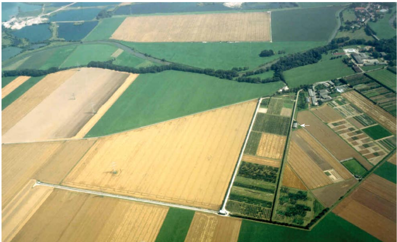
Abb. 5: Luftbild von GEO600. Rechts der Bildmitte das Zentralhaus (Pfeil) mit Laser, Strahlteiler und Signalaufnahme; die 600 Meter langen Messstrecken verlaufen nach rechts oben und nach links, es handelt sich dabei um evakuierte Rohre, die in einem Graben aufgehängt sind; an den Enden stehen Häuser für die Endspiegel. Die Anlage befindet sich in Ruthe, südlich von Hannover. GEO 600 ist ein deutsch-britisches Gemeinschaftsprojekt in Zusammenarbeit der Universitäten von Hannover, Glasgow und Cardiff. (Bild: Deutsche Luftbild, Hamburg)
