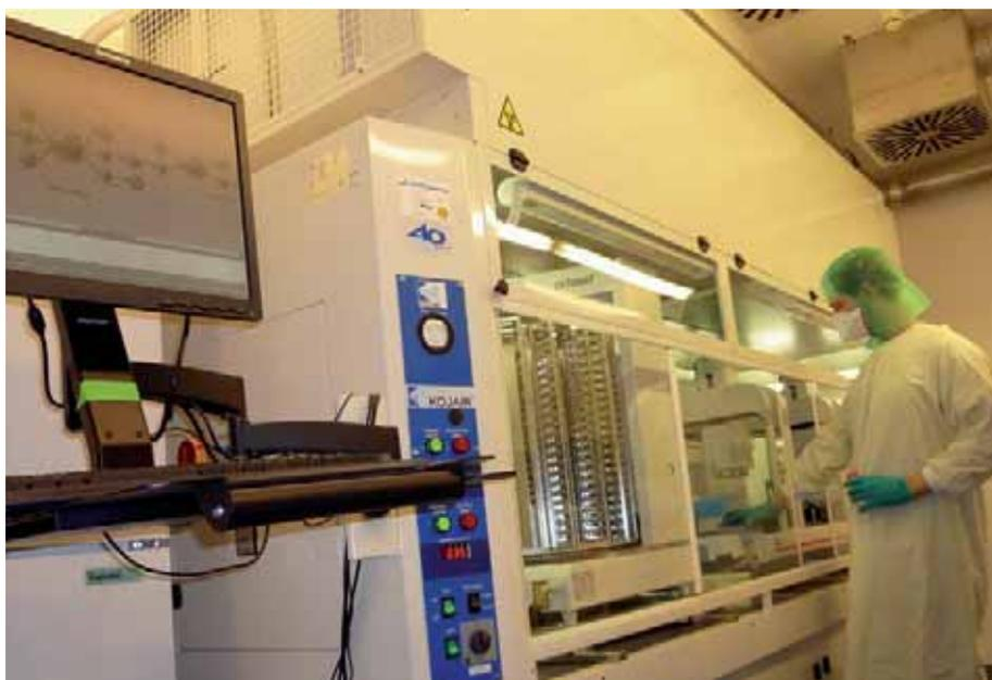
**Abb. 4:** Die neue Hochsicherheits-Screeningeinheit am MPI für Infektionsbiologie Berlin. In der Klasse II-Einhausung sind ein Plattenhotel und der Pipettierroboter zu erkennen.
