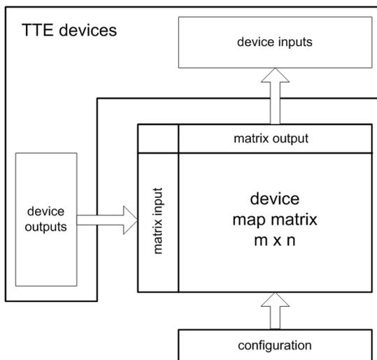
Fig. 1: Schema of TTE device „Device Map Matrix“
