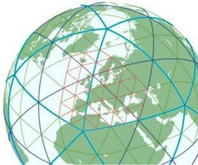
Abb. 1: Beispiel eines globalen ICON-Gitters mit zweifacher regionaler Verfeinerung. Das hellblaue Gitter zeigt das vom Ikosaeder definierte Basisgitter mit 20 dreieckigen Flächen, 30 Kanten und 12 Eckpunkten. Das dunkelblaue Gitter entstand durch eine erste Verfeinerung, in der die Kantenmittelpunkte neue Eckpunkte bilden. Die nächste Gitterverfeinerung wurde nur in der Nordhemisphäre durchgeführt, abgebildet im grünen Gitter. Ein weiterer Verfeinerungsschritt in einer Region über Europa führt dann zum roten Gitter.
