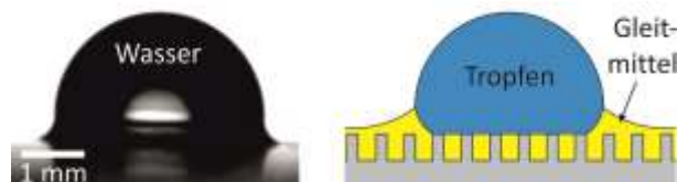
Abbildung 8. Foto und Schema eines Tropfens auf einer Gleitmittel-imprägnierten Oberfläche. Die Oberfläche links war mit dem fluorierten Gleitmittel FC70 imprägniert.
